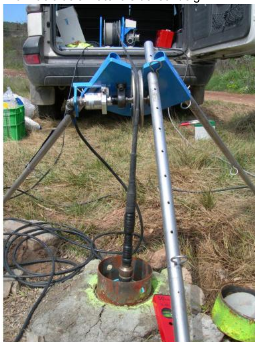
Figura 1. Equip de testificació geofísica. S'observa la sonda dins del sondeig amb el cap unit al cable (dalt). Imatge de la sonda dins del sondeig (baix).
